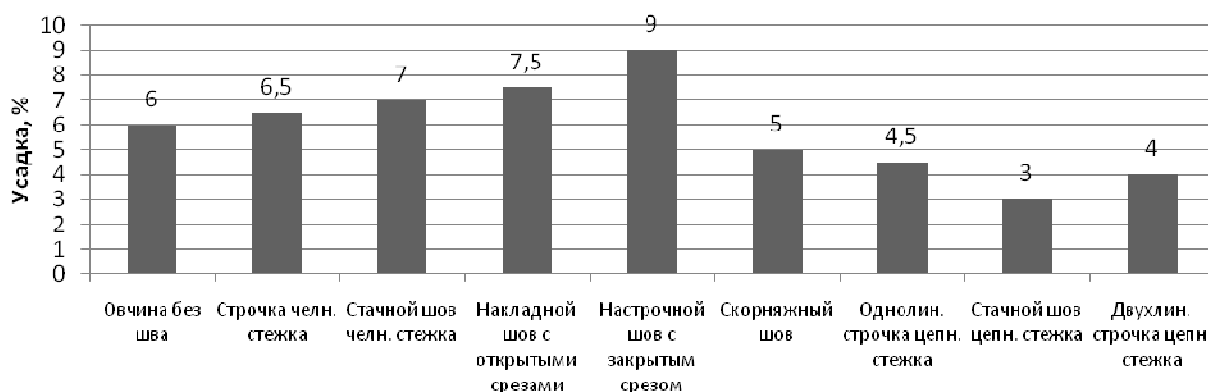
Рис. 2. Усадка швов по длине после химчистки
