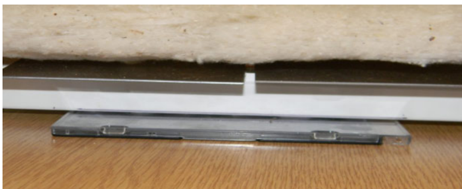
Рис. 3. Расположение нетканого материала над датчиком в процессе контроля
