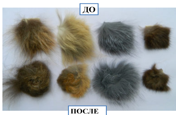
Рис. 2. Внешний вид образцов до и после испытания на устойчивость к истиранию:
