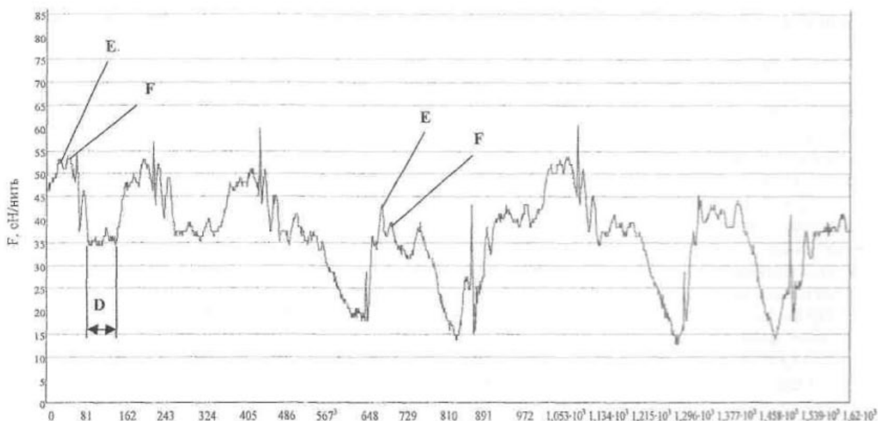
Рис. 3. Фрагмент тензограммы натяжения основной нити
