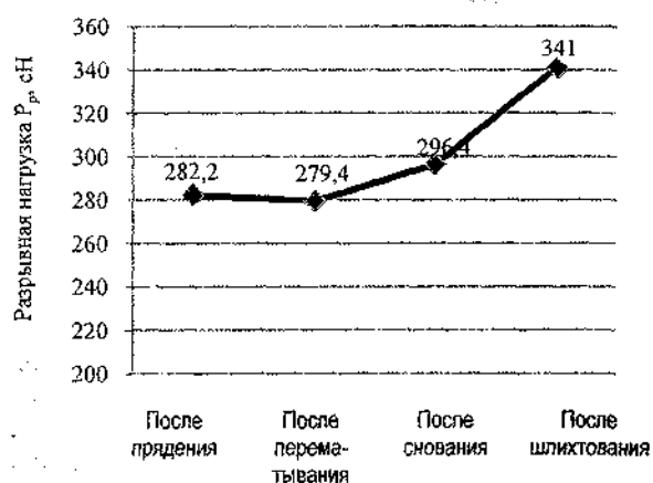
Рис. 1. Изменение полуцикловых характеристик хлопчатобумажной пряжи линейной плотности 29 текс
