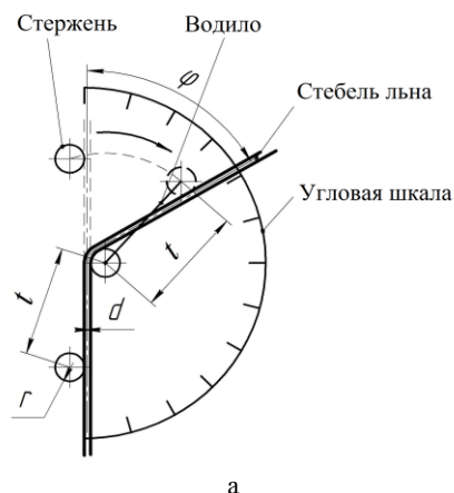
Рис. 1. Лабораторный стенд для определения угла излома стебля:
