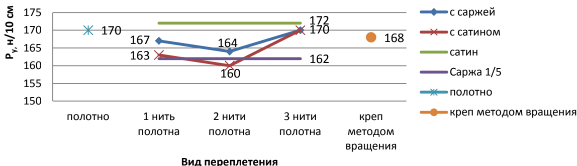
Рис. 1. Зависимость изменения плотности по утку P_y суровых тканей креповых переплетений в процессе отлежки
