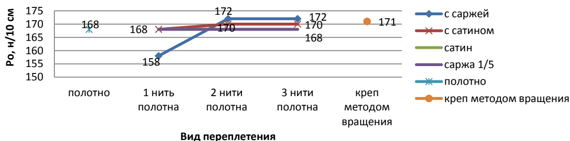
Рис. 4. Зависимость изменения плотности по основе P_o тканей креповых переплетений под воздействием первой мокрой обработки
