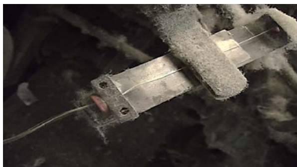
Рис. 1. Тормоз уточной нити с установленным стальным вкладышем
