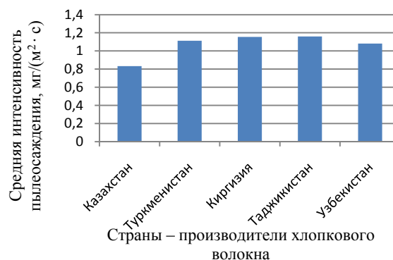
Рис. Средняя интенсивность пылеосаждения, мг/(м 2 ·с) при работе на сырье разных производителей хлопкового волокна
