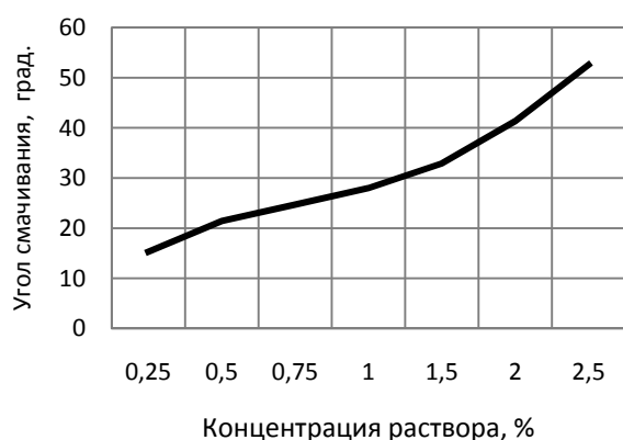
Рис. 2. Зависимость угла смачивания от концентрации раствора
