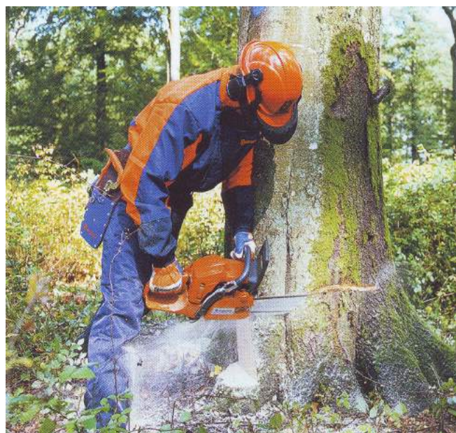
Рис. 2.2. Выполнение наклонного реза
