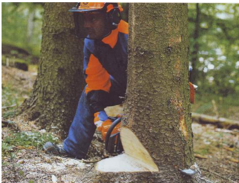
Рис. 2.5. Пропиливание ствола дерева насквозь
