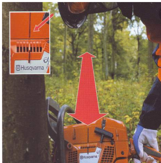
Рис. 2.4. Контроль направления валки
